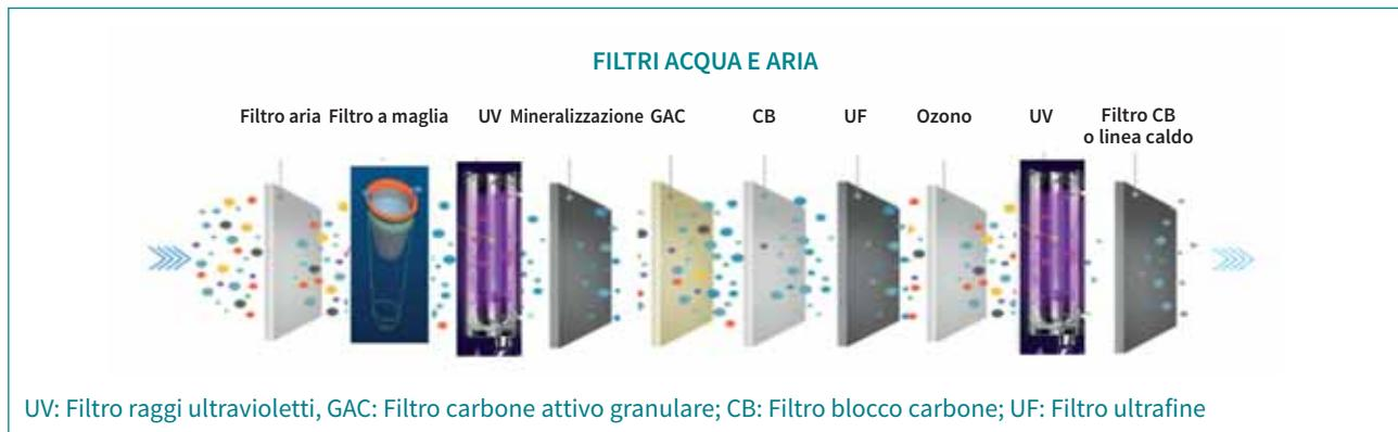
Skywell preleva l'aria e raccoglie l'umidità tramite la condensazione. Una tecnologia di monitoraggio avanzata, in abbinamento con sei filtri, due luci ultraviolette e il trattamento all'ozono, garantisce la purezza di ogni goccia d'acqua. Il sistema inoltre garantisce un monitoraggio continuo per assicurarne elevata qualità, limpidezza e sapore.
