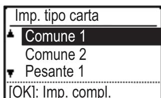
Premere il tasto [FUNZIONE SPECIALE] (Fn), selezionare "Imp. tipo carta" e selezionare il tipo di carta da utilizzare nel vassoio bypass.
