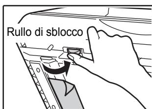
Aprire l'alimentatore di documenti e ruotare il rullo di sblocco nella direzione indicata dalla freccia per far uscire l'originale. Se non si riesce a rimuovere l'originale, rimuoverlo dalla sezione C.
