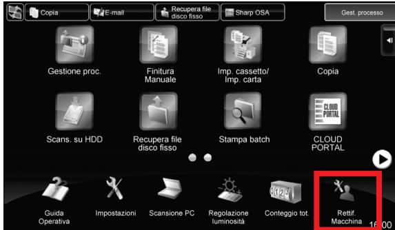
※Quando la macchina è in funzione, la schermata [Regolazione macchina] non è accessibile. Toccando [Regolazione macchina], vengono visualizzati i seguenti messaggi, accompagnati da una segnalazione acustica: la Regolazione macchina non è disponibile a causa del lavoro al momento riservato/eseguito.
