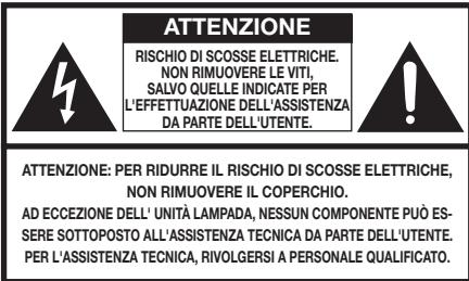
Il simbolo con il fulmine con la punta a freccia all'interno di un triangolo equilatero serve per avvertire l'utente della presenza di "tensione pericolosa" non isolata, all'interno dell'involucro del prodotto; essa risulterà essere di entità sufficiente a dare luogo a rischi di scosse elettriche per le persone.
