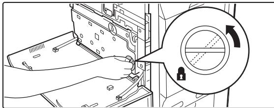
! Se la leva di bloccaggio non ruota, verificare che la vaschetta raccogli toner sia installata correttamente. In particolare, assicurarsi che l'angolo in alto a sinistra della vaschetta raccogli toner sia in posizione.
